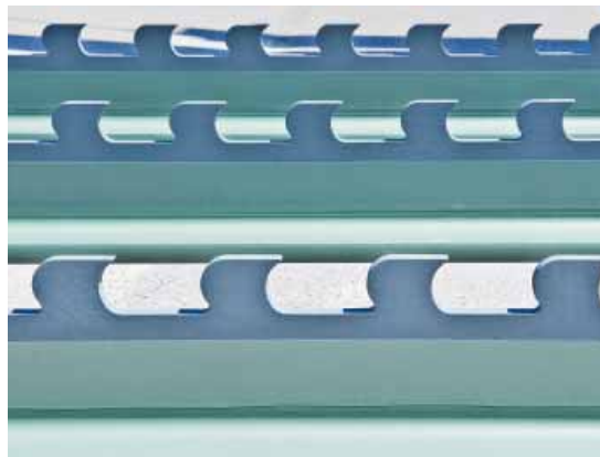
Korrosionsgeschützter Träger nach dem Transport ins Fertigteilwerk
