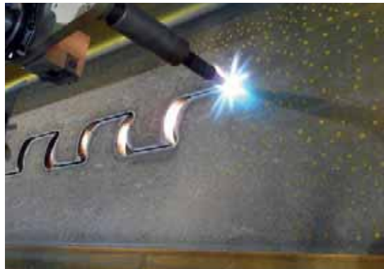
Brennschneiden des Walzträgers
