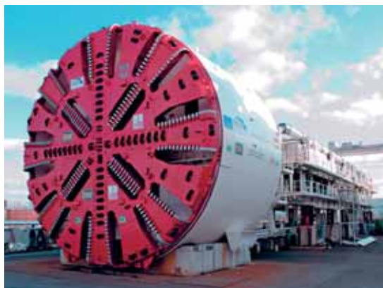
TBM Mixschild 13 m Durchmesser – vergleichbarer Typ Fa. Herrenknecht
