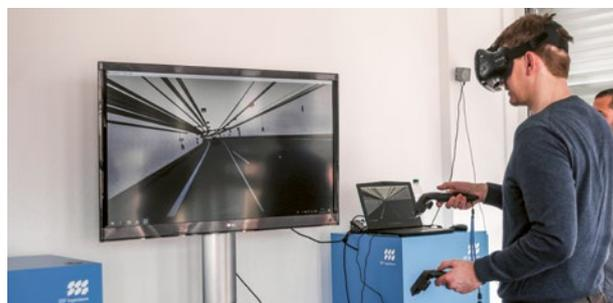
Messila der "Green Line" in Doha aus diesem neuen Blickwinkel betrachtet. Denn VR-Simulationen, basierend auf dem Einsatz von BIM in der Planung, bieten unzählige Vorteile: die Anschaulichkeit des Modells wird verbessert, der Bauablauf optimiert und die Zusammenarbeit zwischen allen Projektbeteiligten vereinfacht. ■
