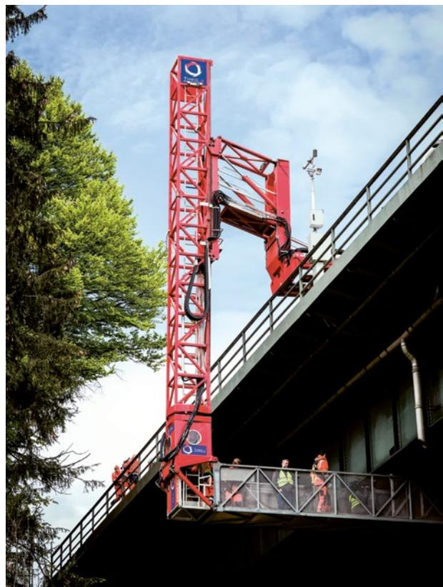
**DAS BRÜCKENUNTERSICHTSGERÄT AN DER PRIENTALBRÜCKE AUF DER A8**
