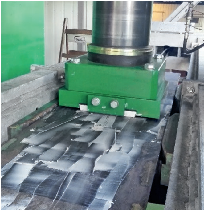
Bild 10 Versuch zur Ermittlung des Reibkoeffizienten vor dem Querverschub Experiment to determine the coefficient of friction before the transverse sliding
