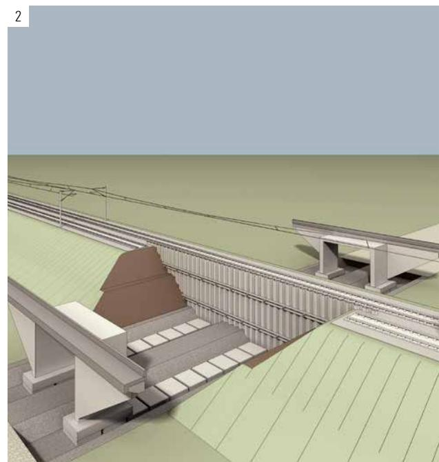
**Brückenneubau** – Beispiel „Bauen unter Hilfsbrücken; dargestellt die Herstellmethodik für den Bau des neuen Widerlagers
