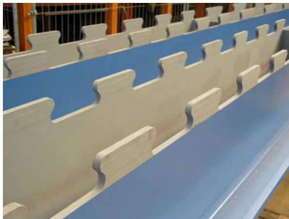
Abbildung 5: Halbierter Walzträger mit „Puzzle“-Geometrie der Verbunddübelleiste
