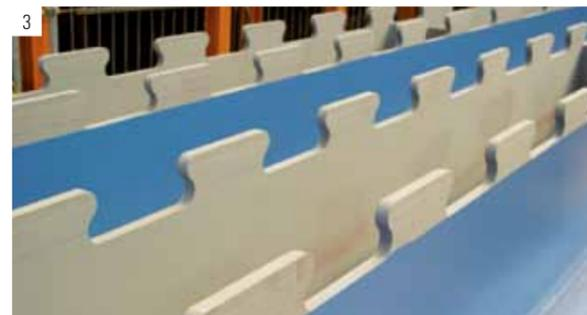
mit drei Brennköpfen automatisch in einem Arbeitsgang und entsprechend der vorgegebenen Ausnehmungsgeometrie getrennt wurden. Durch das maschinelle Verfahren wird ein sauberer Schnitt und eine hervorragende Ebenheit der Brennflächen gewährleistet.
