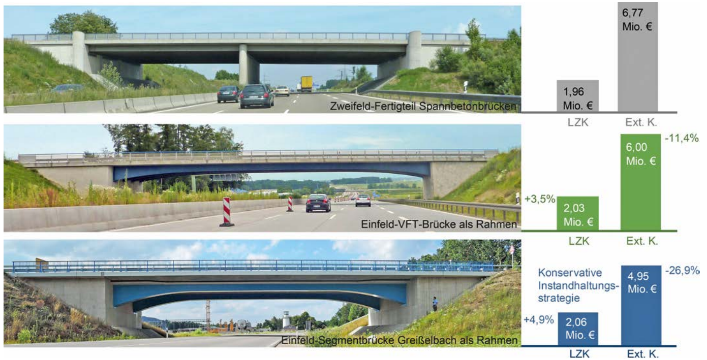
Bild 11. Gegenüberstellung Lebenszykluskosten (LZK) und externe Kosten (ext. K.) für die Brückenvarianten Fig. 11. Comparison of Life-Cycle Costs (left) and external costs (right) for the bridge variants
